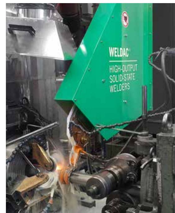
Weldac może być wyposażony w różne cewki indukcyjne, które są bardzo łatwe do wymiany.
