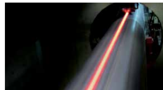
Ruch orbitalny cewek w tym systemie normalizacji ENRX umożliwia precyzyjne śledzenie spoiny. Normalizacja jest niezbędna dla rur stosowanych w przemyśle naftowym i gazowym.
