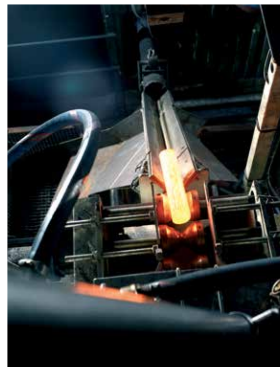
Pionowa nagrzewnica częściowa ENRX. Systemy te mogą być wyposażone w dowolną liczbę cewek indukcyjnych i są dostępne w wersjach z tranzystorami IGBT lub tyrystorami.
