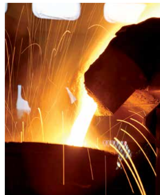
Jednoosiowy piec uchylny ENRX. Systemy tego typu mogą topić metale żelazne i nieżelazne (stopy miedzi i aluminium). Dostępnych jest kilka modeli dostosowanych do różnych potrzeb w zakresie pojemności. Piece oferowane są zarówno z łatwymi do wymiany prefabrykowanymi tyglami, jak i z wykładzinami ubijanymi.
