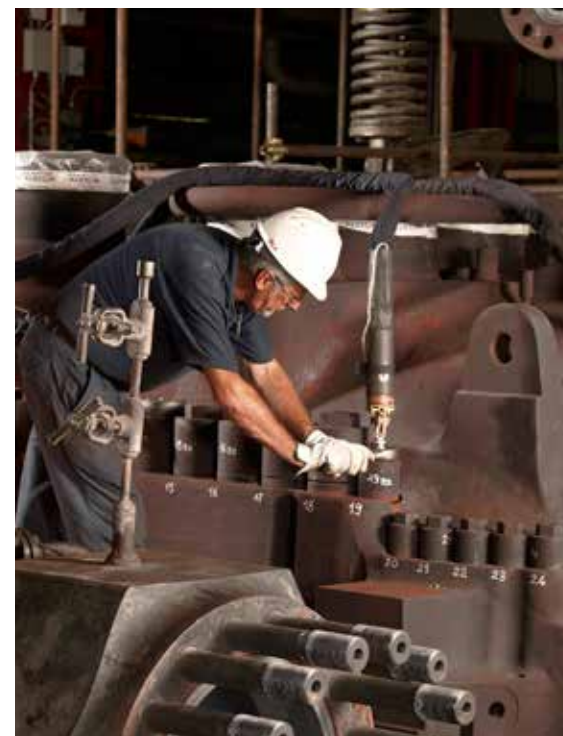
Przykład pasowania skurczowego – urządzenia ENRX umożliwiają demontaż dużych nakrętek i śrub w ułamku czasu potrzebnego przy tradycyjnym nagrzewaniu gazowym lub oporowym.
