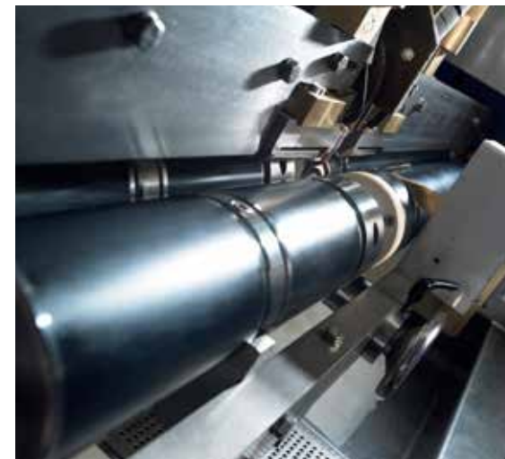
Wał poruszający się z dużą prędkością przez cewkę indukcyjną. Odpuszczanie indukcyjne nie ma sobie równych pod względem szybkości i precyzji.
