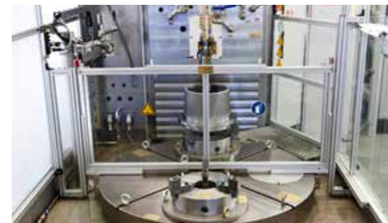
Kompletny system odpuszczania ENRX zazwyczaj obejmuje źródła zasilania, cewki, mechanizmy podające oraz oprogramowanie sterujące. Dostępne są również opcje szkolenia, konserwacji i serwisu.
