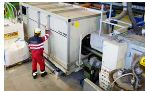
Średnioczęstotliwościowy system ENRX Sinac wstępnie nagrzewa bezszwową rurę offshore przed nałożeniem powłoki.
