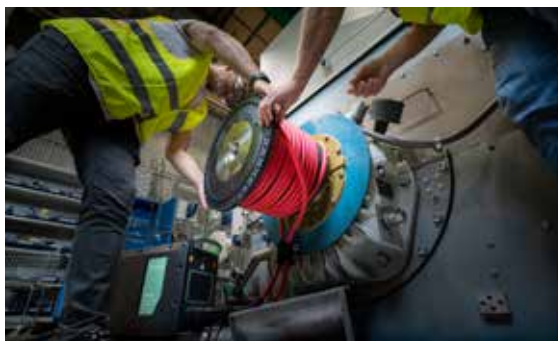
Powietrznie chłodzony system nagrzewania indukcyjnego Ventac doskonale sprawdza się w zastosowaniach do pasowania skurczowego.
