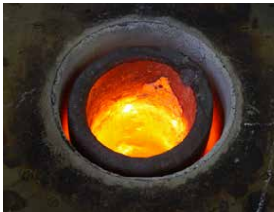
Stopiony mosiądz w piecu do topienia z ruchomą cewką. Prefabrykowany (gliniano-grafitowy) tygiel pozostaje nieruchomy przez cały cykl topienia. Zamiast tego, cewka porusza się wokół tygla, nie dotykając go. Specjalne tygla – pełniące jednocześnie funkcję kadzi odlewniczych – eliminują ryzyko zanieczyszczenia stopów.
