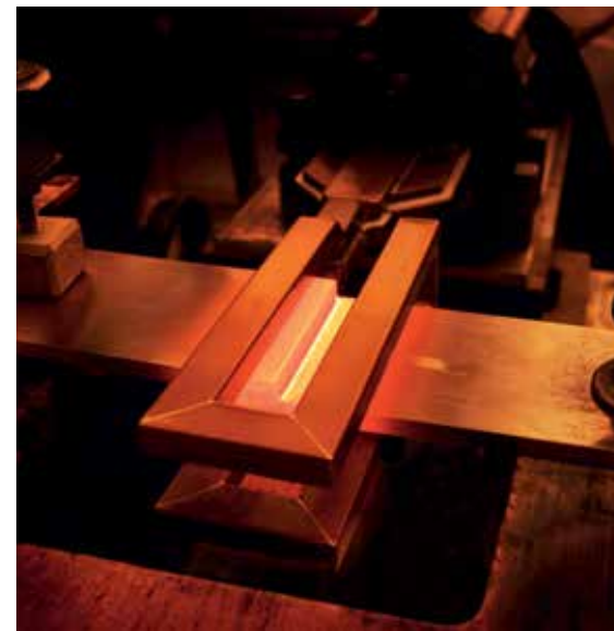
Lutowanie z użyciem systemu ENRX. Zwróć uwagę, że strefa nagrzewania jest w pełni widoczna – co jest praktycznie niemożliwe w przypadku lutowania płomieniowego.
