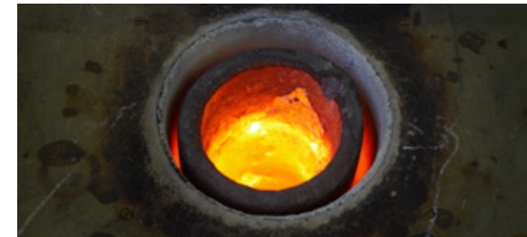
Ein einachsiger ENRX-Kipptiegel-Ofen kann Eisen- und Nichteisenmetalle wie Kupfer- und Aluminiumlegierungen schmelzen. Verschiedene Modelle erfüllen unterschiedliche Kapazitätsanforderungen und sind mit leicht austauschbaren Standardtiegeln oder geramten Auskleidungen verfügbar.
