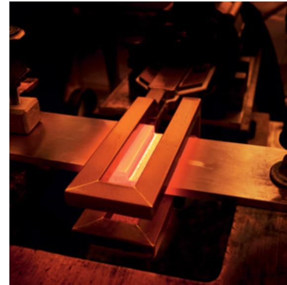
Löten mit einem ENRX-System. Beachten Sie, dass die Heizzone vollständig sichtbar ist. Das ist beim Flammlöten aufgrund der grellen Flamme nicht möglich.
