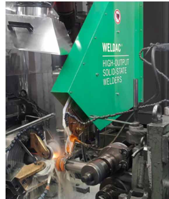
Ein Weldac kann mit verschiedenen Induktionsspulen ausgestattet werden, die sehr einfach zu wechseln sind.
