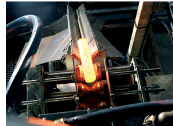
Heißer Schmiederohling nach einer Schmiedestation von ENRX
