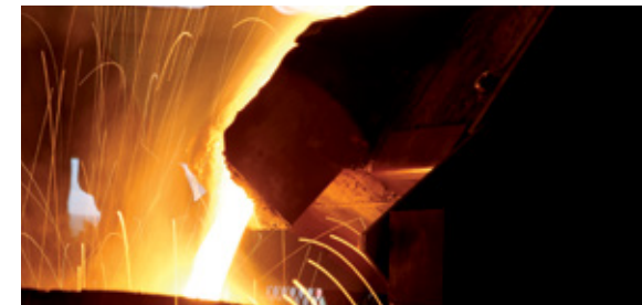
Geschmolzenes Messing befindet sich in einem stationären Schmelztiegel aus Tongraphit, während sich der Induktor berührungslos um den Tiegel bewegt. Der Schmelztiegel dient gleichzeitig als Gießpfanne, wodurch eine Verunreinigung der Schmelze mit anderen Metallen vermieden wird.
