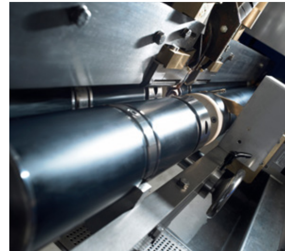
Eine Welle, die sich mit hoher Geschwindigkeit durch eine Induktionsspule bewegt. Das induktive Anlassen ist in seiner Geschwindigkeit und Präzision unübertroffen.
