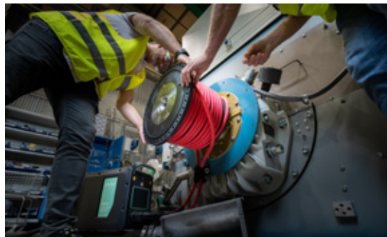
Die luftgekühlte Induktionsanlage Ventac ist ideal für Schrumpfanwendungen.
