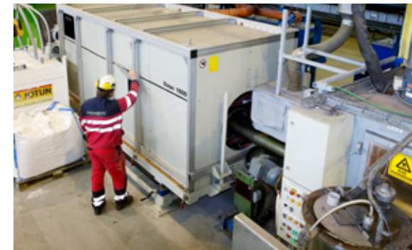
Die Sinac von ENRX, ein Mittelfrequenz- Induktionswärmegerät, wärmt nahtlose Offshore Rohre vor, bevor diese beschichtet werden.
