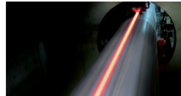
Die schwenkbaren Induktionsspulen dieser Anlage von ENRX zum Normalglühen gewährleisten die zielgenaue Nachverfolgung des Verlaufs der Längsschweißnaht. Das Normalisieren ist ein wesentlicher Bearbeitungsschritt bei der Herstellung von Rohren für die Öl- und Gasindustrie.
