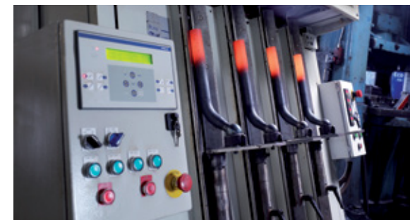
ENRX Schmiedemaschine für Stabenden (Anhängerkupplungen). In IGBT- und Thyristorausführung erhältlich.
