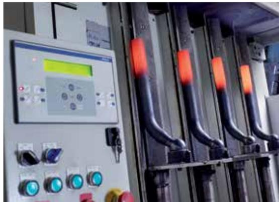
Une billette d'acier chauffée dans une station de forge ENRX.
