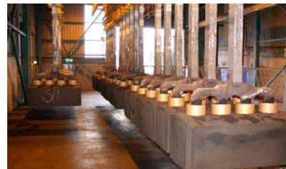
*Aucune poussière, aucune fumée, aucun bruit. Un système de chauffage ENRX prend en charge des goujons d'anode de 170 millimètres.*
