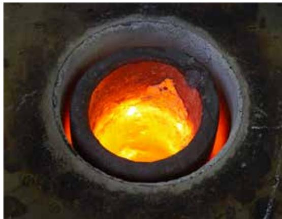
*Laiton en fusion dans un four à fusion à inducteur mobile. Le creuset préfabriqué (en graphite d'argile) reste statique pendant tout le cycle de fusion. À la place, l'inducteur se déplace autour du creuset sans le toucher. Les creusets dédiés, qui servent également de louche de coulée, éliminent la contamination entre alliages.*
