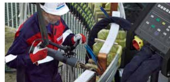
*Un Minac ENRX réalise le brasage de bobinages de générateur. La mobilité du Minac et son transformateur portatif permettent aux opérateurs d'accéder facilement aux zones difficiles d'accès.*
