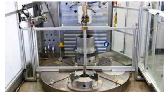
*Un système complet de revenu ENRX comprend généralement des sources d'énergie, des bobines, des mécanismes de manutention et un logiciel de contrôle. Des options de formation, de maintenance et de services sont également disponibles.*
