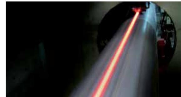
*Le mouvement orbital des bobines sur ce système de normalisation ENRX permet un suivi précis du cordon de soudure. La normalisation est essentielle pour les tuyaux utilisés dans l'industrie pétrolière et gazière.*
