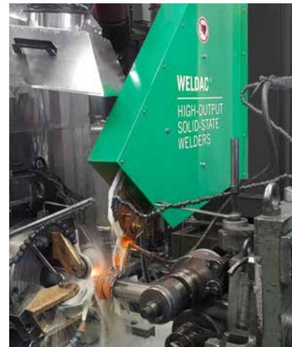
*Le système Weldac peut être équipé de différentes types d'inducteur, très faciles à remplacer.*
