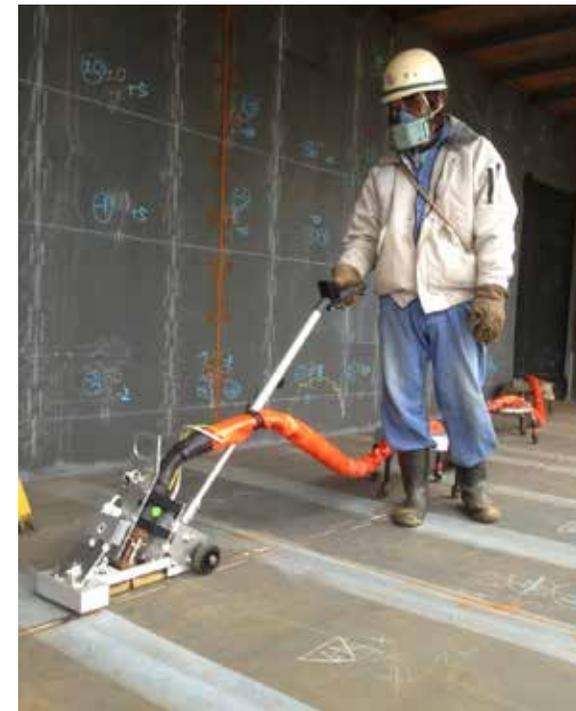
*Un système Terac d'ENRX garantit un fonctionnement sécurisé – il est impossible de surchauffer l'acier magnétique. De plus, le Terac ne génère aucun gaz toxique provenant de la source de chaleur. Et il ne produit aucune nuisance sonore.*
