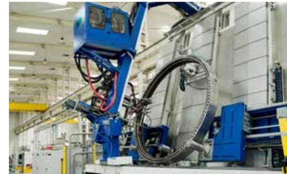
*Une solution ENRX est utilisée pour durcir les énormes anneaux de rotation utilisés dans les éoliennes.*
