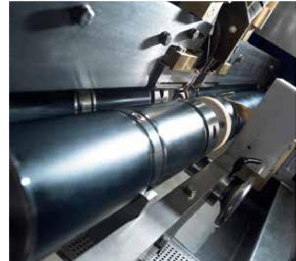
*Un arbre tournant à grande vitesse à travers une bobine à induction. Le revenu par induction est inégalé en termes de vitesse et de précision.*
