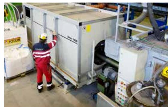
*Un système Sinac ENRX à moyenne fréquence préchauffe un tuyau offshore sans soudure avant le revêtement.*
