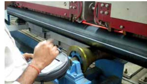
*Le système de contrôle aide à relever les défis posés par la normalisation des cordons de soudure sur la nouvelle génération de tuyaux conformes à la norme API.*
