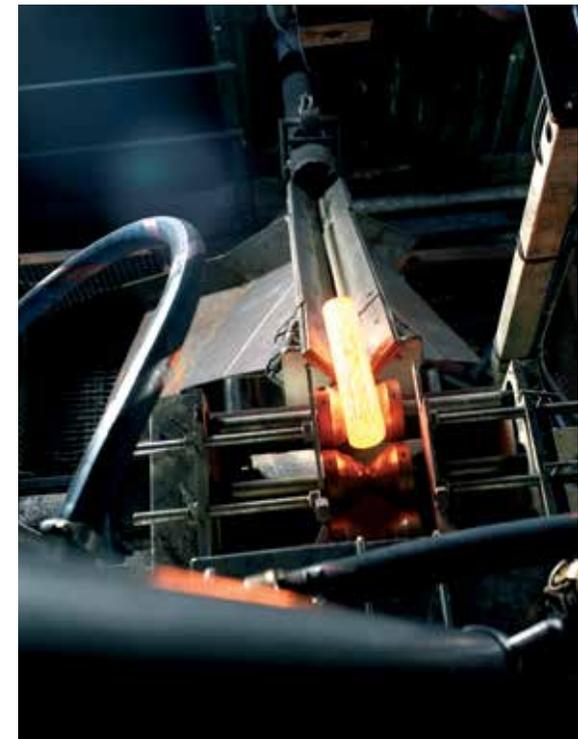
Un réchauffeur partiel vertical ENRX. Ces systèmes peuvent être équipés d'un nombre quelconque de bobines à induction, et sont disponibles en versions IGBT et thyristor.
