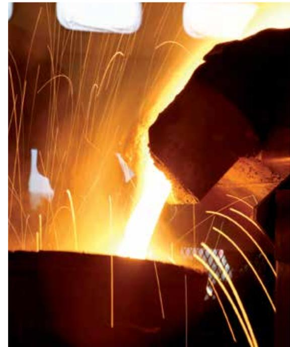
*Un four ENRX basculant à un axe avec coulée intégrée. Ces systèmes permettent de faire fondre des métaux ferreux et non ferreux (alliages de cuivre et d'aluminium). Plusieurs modèles sont disponibles pour répondre à tous les besoins de capacité. Ils sont proposés avec des creusets préfabriqués faciles à changer ou des garnitures damées.*
